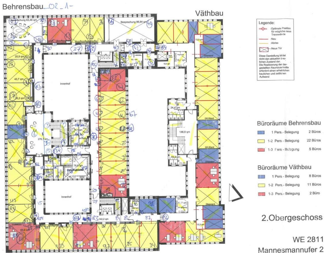
Abb. 9: Grundrissplan mit vermerkten Scannerpositionen und -nummern<sup>53</sup>
