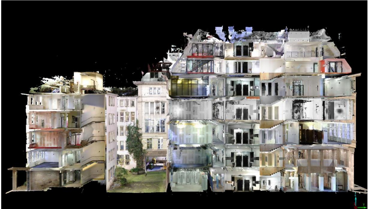
**Abb. 24:** Erstellung eines Schnitts mithilfe der *Clipping Box*<sup>70</sup>
